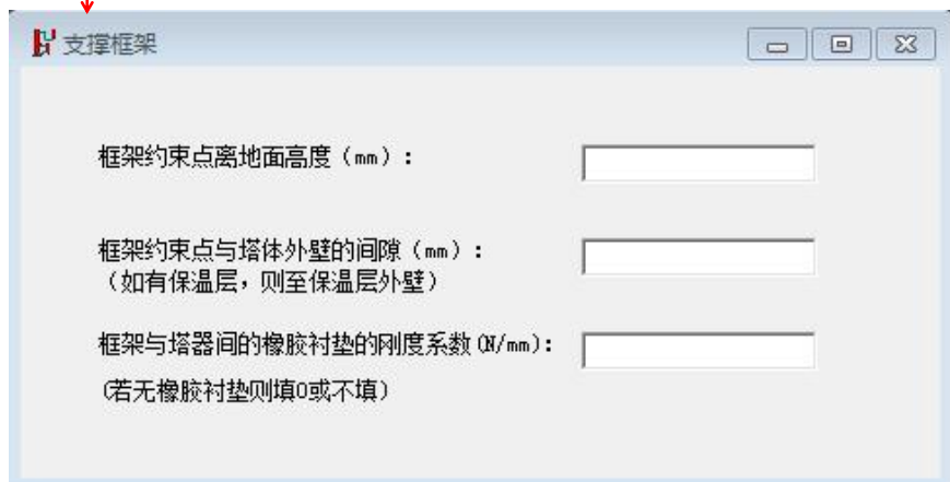
图 11.19 支撑框架数据输入
